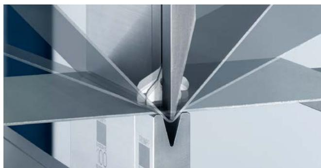
Sistema táctil de medición angular ACB Wireless.
