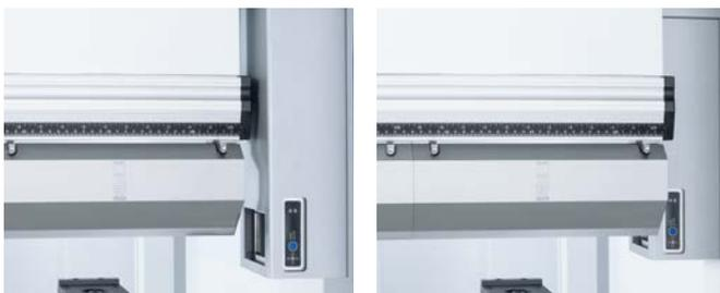
Para el equipamiento lateral de la máquina con útiles, el BendGuard se puede desplazar hacia atrás.
